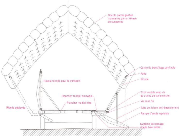
Schéma de la plateforme de 22 m<sup>2</sup> sur remorque surmontée de sa conque.
